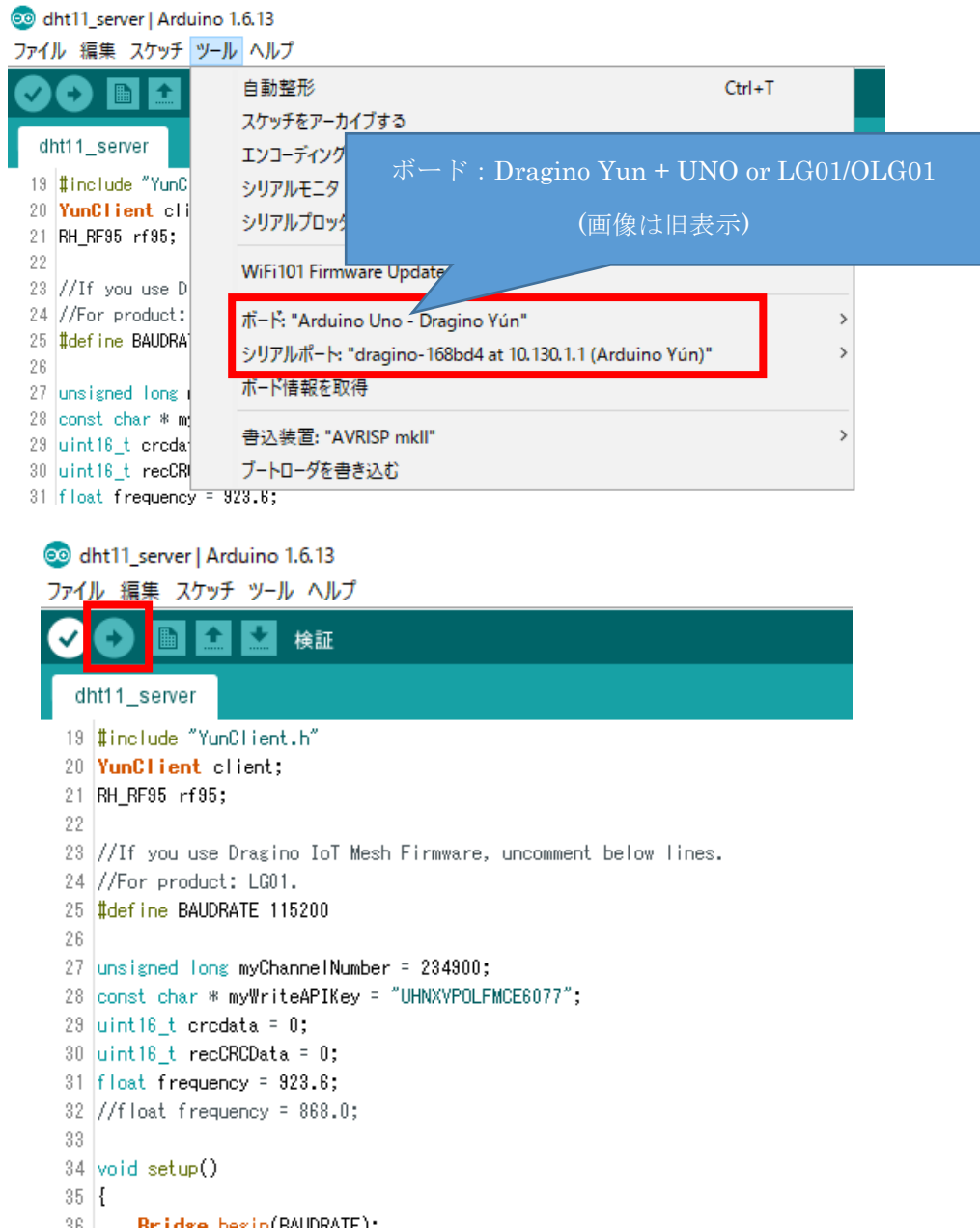
図 9.ゲートウェイプログラムの書き込み
